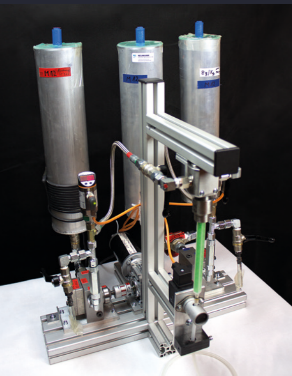
Dosiersystem mit Einweg-Mischer mit zus. Farbbehälter Dosing system with disposable mixer with additional paint container
