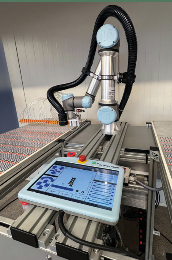
UR Roboter mit 6 Achsen für komplexe Aufgaben UR robot with 6 axes for advanced tasks
