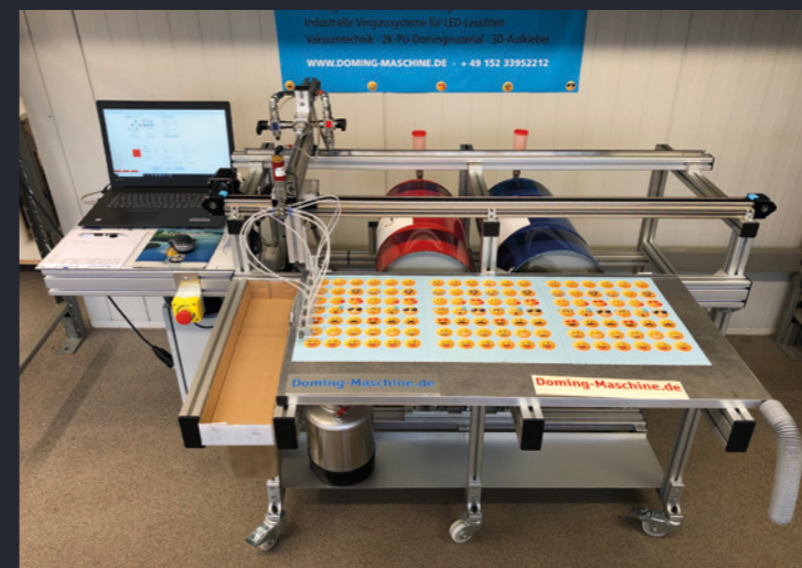
Doming-System mit einem Verfahrweg von 1.200 mm Doming system with a travel path of 1,200 mm
