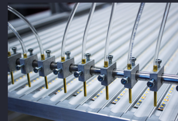
Aufrüstbar mit bis zu 48 Auftragsdüsen Upgradable with up to 48 application nozzles
